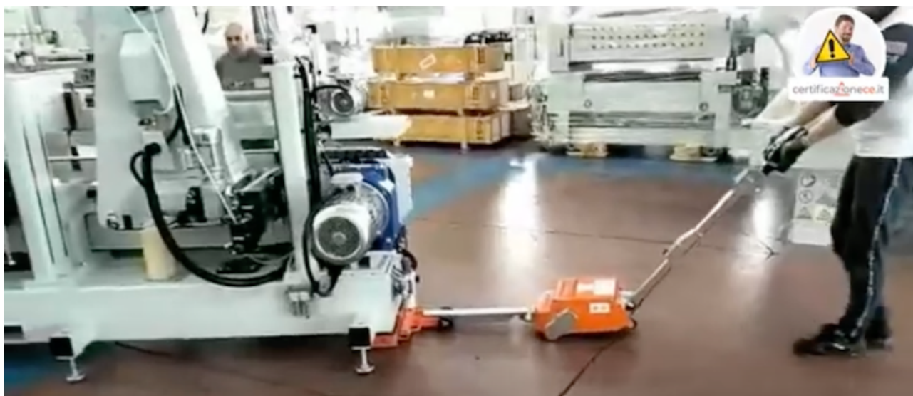
Esempio di movimentazione macchina con rulliera sterzante e carrelli fissi a pochi centimetri dal suolo
