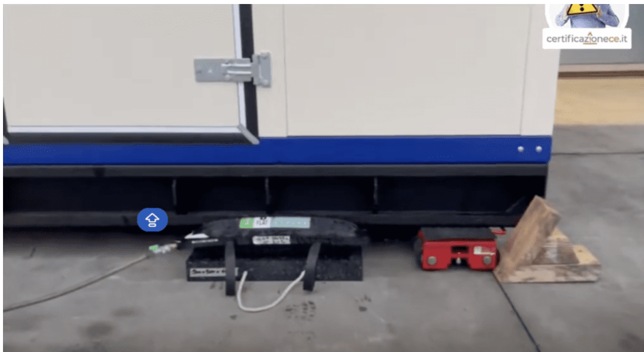
Esempio di cuscino ad aria per il sollevamento di macchinari
